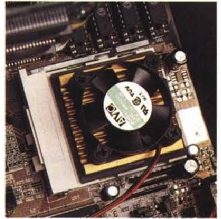
Il microprocessore, ovviamente dotato di dissipatore e ventolina dedicata.
